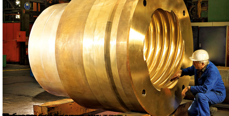
Изготовление шпindelной гайки изменения вылета стрелы портального крана «Марabu» GZ-CuSn10 2.1050.03 DIN 1705
