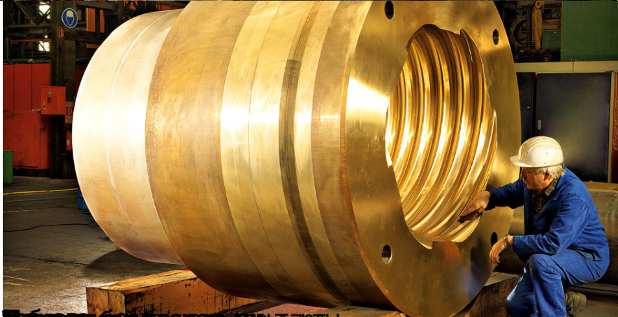
Изготовление шпindelной гайки изменения вылета стрелы портального крана «Марabu» GZ-CuSn10 2.1050.03 DIN 1705
