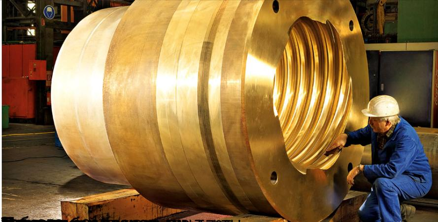
Изготовление шпindelной гайки изменения вылета стрелы портального крана «Марабу»
